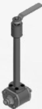
Шаровые краны для криогенных сред DN 15–50 PN 1,6 МПа с температурой эксплуатации до минус 196°C. Данная номенклатура отличается высокой точностью изготовления деталей и отсутствием в конструкции уплотнительных элементов на основе резины. Краны применяются на установках сжижения газов.
