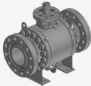
Шаровые краны DN 10–300 PN 1,6–25,0 МПа, разработанные по требованиям СТО Газпром и МУК ЕТТ Роснефть. В конструкции данных кранов предусмотрены системы принудительного уплотнения рабочих органов, находящихся под давлением. Это дает возможность увеличения ресурса до капитального ремонта изделий.
