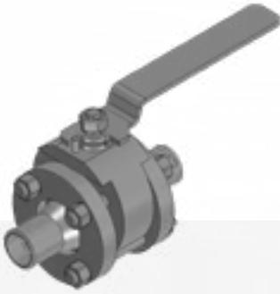
Шаровые краны для АЭС, в т.ч. с уплотнением «металл-по-металлу» DN 10–150 PN 4,0 МПа. Краны разработаны в двух исполнениях по узлу затвора: «мягкое» и «металл-по-металлу». Конструкция изделий имеет картридную конструкцию, позволяющую проводить планово-предупредительные работы на трубопроводе с минимальным временем на ремонт и замену изношенных деталей.
